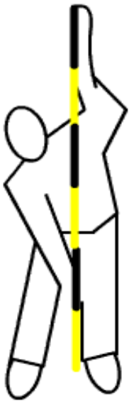
figure 10: tenue de la sonde pour ne pas la tordre.
